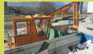
Depuis l'an dernier, les déchèteries du Trièves disposent chacune d'un compacteur. Ce véhicule étrange permet, grâce à un gros cylindre cranté, d'écraser le contenu des bennes afin d'augmenter leur volume. Cela permet de baisser le nombre de trajets nécessaires pour acheminer les déchets dans les sites ultimes de retraitement. L'achat de ces deux compacteurs a bénéficié d'importantes subventions du Département.
